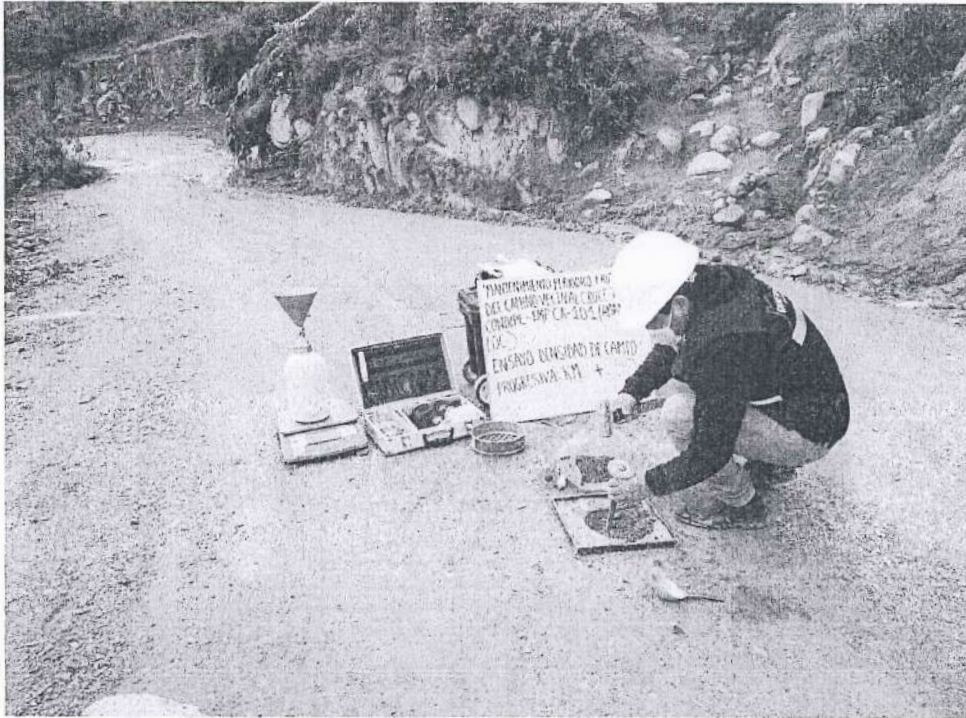
FOTOGRAFÍA N°11. Ensayo N°11 de Densidad de Suelo en Campo (Método del cono de arena) en la progresiva Km 13+250.
