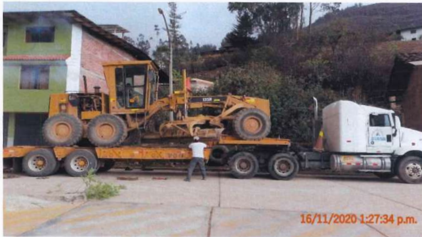
Fotografía 31. Movilización de una motoniveladora modelo 135H, desde la ciudad de Cajamarca a obra (Entrada a la ciudad de Contumazá)
