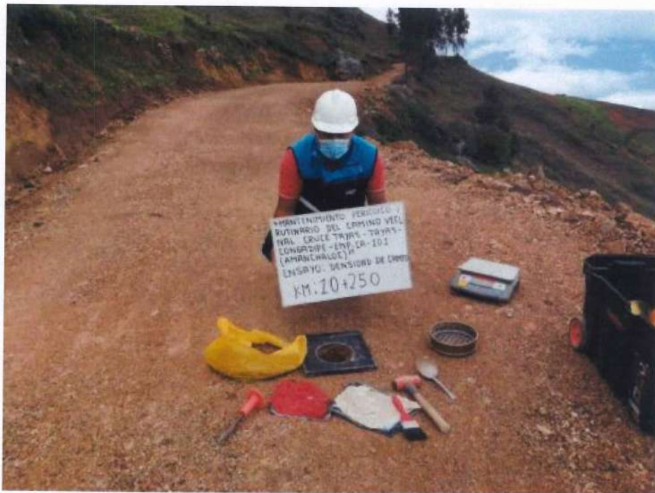
Fotografía 116. Densidad de campo el km 10+250.
