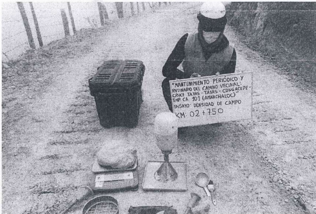
FIGURA 12. Ensayo de Densidad de Suelo en Campo en la progresiva Km 02+750
