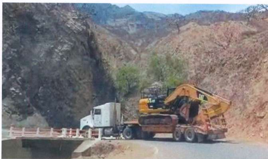
Fotografía 3: Movilización de excavadora 320 2L CAT desde Cajamarca a la obra.
