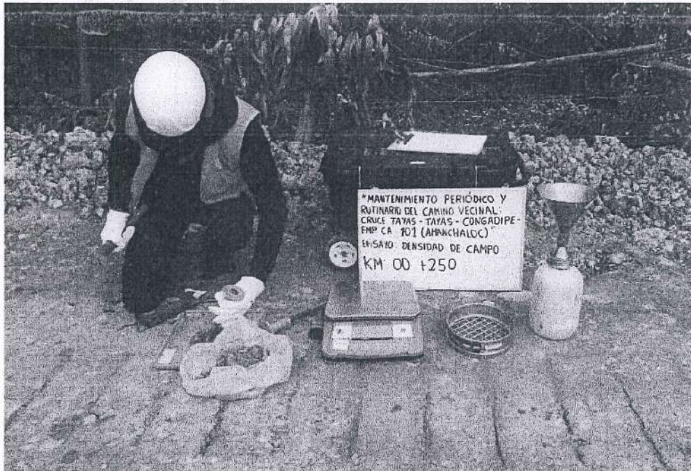
FIGURA 2. Ensayo de Densidad de Suelo en Campo en la progresiva Km 00+250
