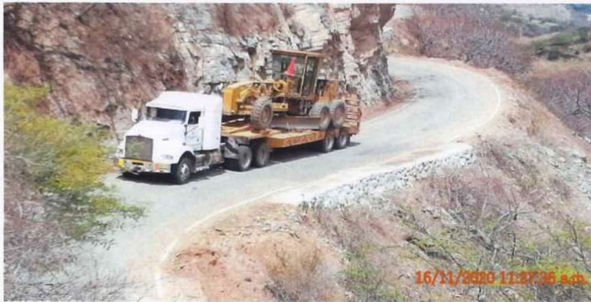
Fotografía 30. Movilización de una motoniveladora modelo 135H, desde la ciudad de Cajamarca a obra (Carretera Chilete – Contumazá).
