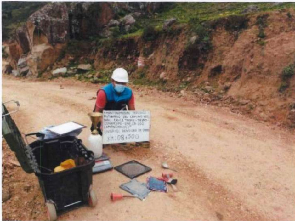
Fotografía 109. Densidad de campo el km 08+500.
