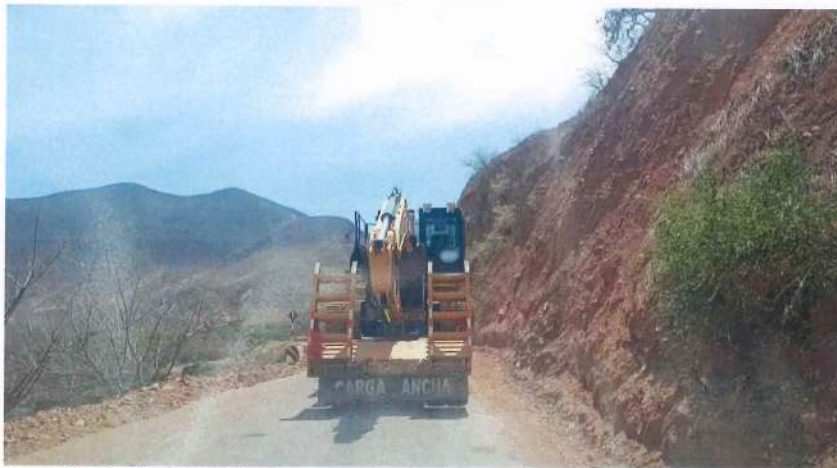
Fotografía 2: Movilización de excavadora 320 2L CAT desde Cajamarca a la obra.
